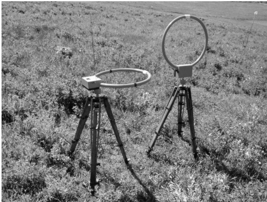
Рис.2 Дипольный индуктивный структуроскоп СДИ К-5
